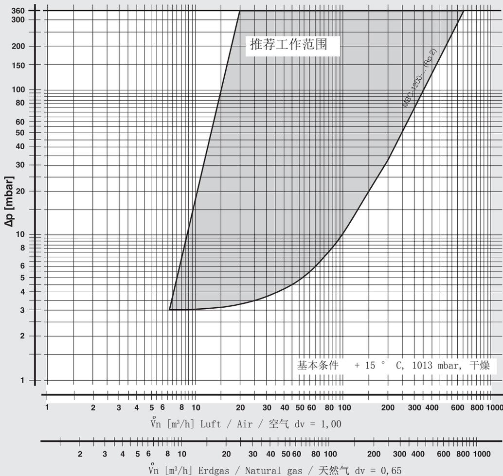
$$f = \sqrt{\frac{\text{空气密度}}{\text{所使用燃气的密度}}}$$
