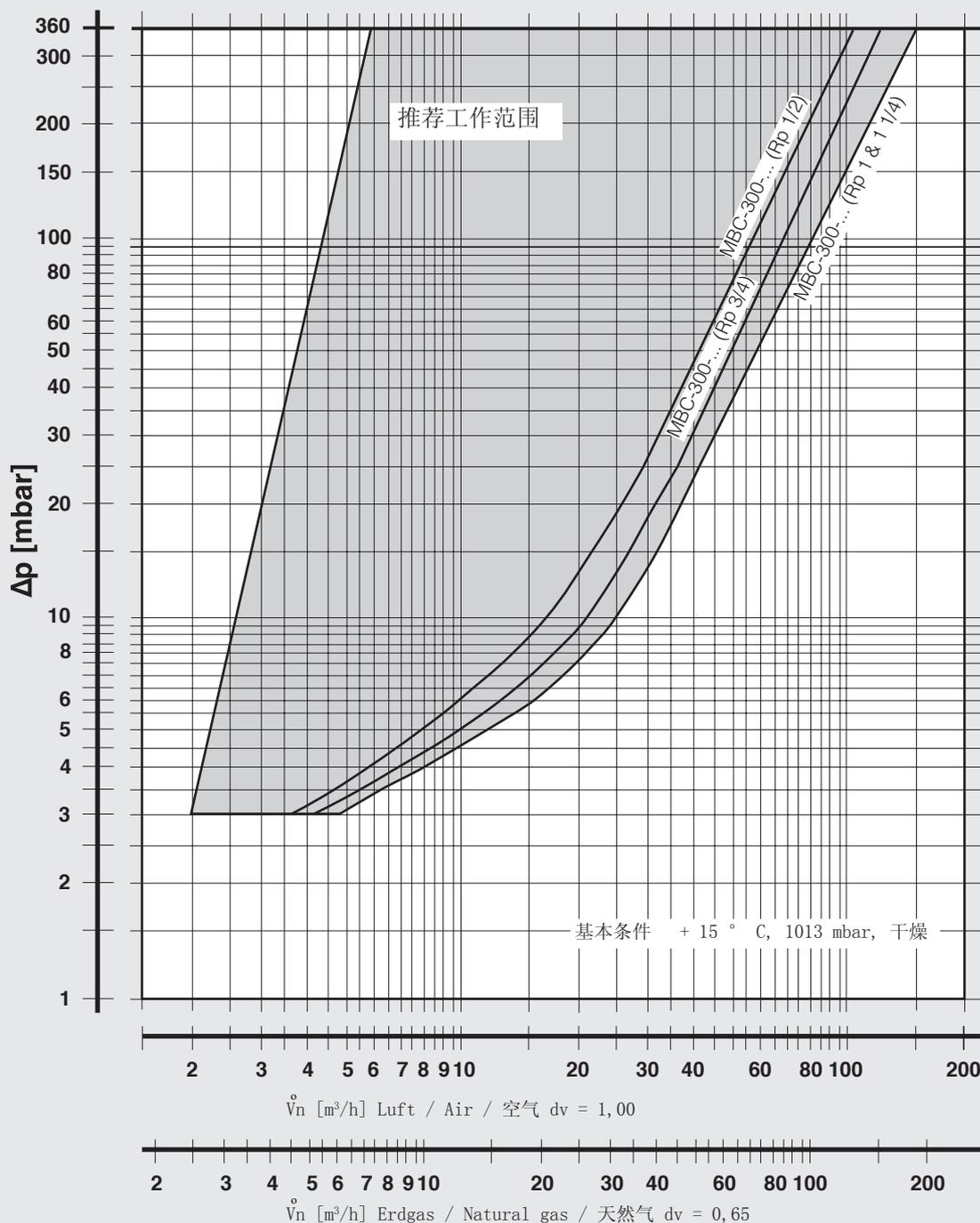
配有精细过滤器且稳定状态下的体积流量-压力差特性曲线。
